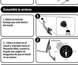
Debés aflojar las tuercas del soporte para Recomendaciones poder deslizar el mástil a través de él
